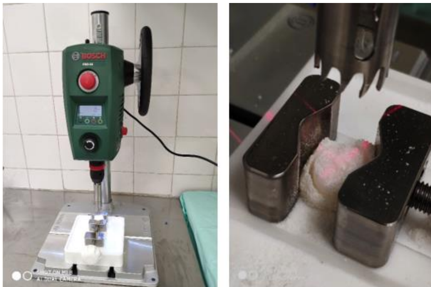
Εικόνα 2: α) Διάταξη β) Χρήση laser για σωστή τοποθέτηση του οστικού τεμαχίου στη κατάλληλη εισδοχή.
